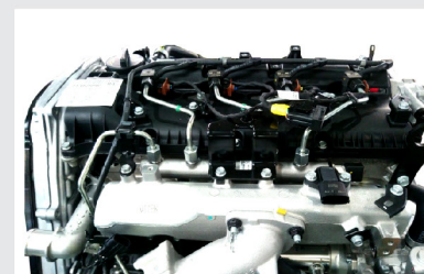
Hệ thống phun nhiên liệu điều khiển điện tử CRDi(Common Rail Direct injection), turbo tăng áp.
