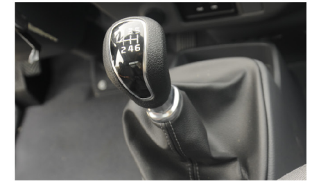
Cần số (6 số tiến, 1 số lùi) thiết kế kiểu xe du lịch.
