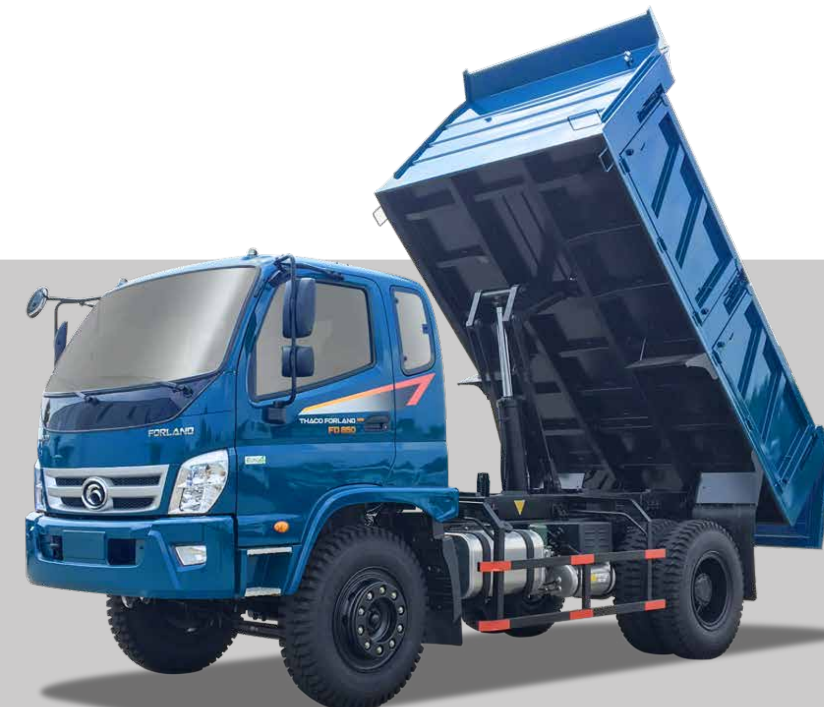
Thùng ben thiết kế mới, kết cấu cứng vững, khả năng chịu tải lớn. Tôn sàn dày 4 mm, chế tạo từ thép có độ bền cao
