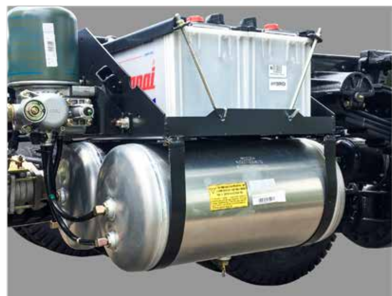
Bình khí nén chế tạo từ hợp kim nhôm, phanh tay lốc kê
