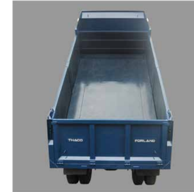
Thùng ben thiết kế mới, kết cấu cứng vững, khả năng chịu tải lớn. Tôn sàn dày 4 mm, chế tạo từ thép có độ bền cao
