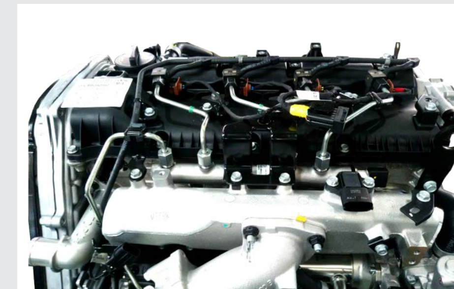
Hệ thống phun nhiên liệu điều khiển điện tử CRDi (Common Rail Diesel injection)
